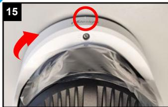
Drehen Sie die Kamera in Pfeilrichtung, bis die Kerbe der Anschlussplatte an der Markierung ist.
