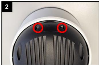
Schrauben lösen und Abdeckung abnehmen.
