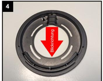
4 Kamera so ausrichten, dass die geschlossene Seite in Blickrichtung schaut.
