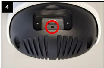
Für Reset: Fünf Sekunden lang die Taste gedrückt halten. Dann Abdeckung wieder aufsetzen und Schrauben festziehen.
