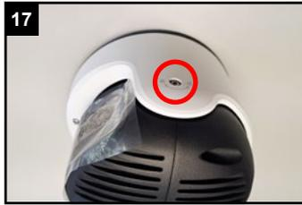
Zum Einstellen des Neigungswinkels die seitliche Schraube ein wenig lockern. Anschließend wieder festziehen.
