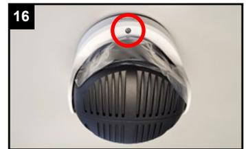
Schraube wieder festziehen und Halt der Kamera prüfen.
