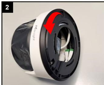
2 Schwarze Montageplatte auf der Rückseite in Pfeilrichtung drehen und abnehmen.
