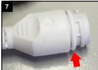
7 O-Ring auf Netzwerkbuchse am Kabel der Kamera setzen.
