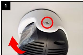
Schraube ein wenig lockern und Kamera neigen, bis die hintere Abdeckung zugänglich ist.
